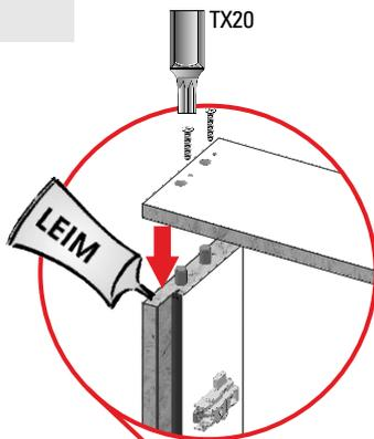
**2 Rahmen in Wand einsetzen und ausrichten:**
